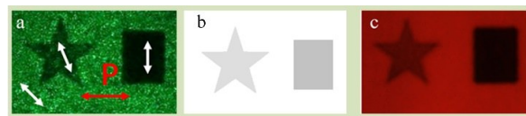
图4 (a) SLM 产生的偏振光场(透过水平线偏振片观察),其中红色箭头表示偏振片的透光轴方向,白色箭头分别表示三个区域的偏振方向;(b) SLM 上加载的曝光图案;(c) 正交偏振片下的液晶器件图像 [25]
